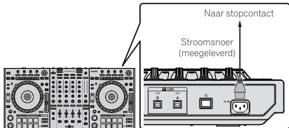
6 Druk op de [ $\odot$ ]-schakelaar op het achterpaneel van dit toestel om het toestel in te schakelen.
