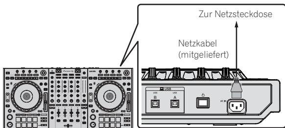
6 Drücken Sie den [⊕]-Schalter an der Rückseite dieses Geräts, um es einzuschalten.
